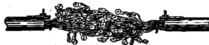
Рис. 4.11. Срасток жил, выполненный соединителем UY2.
