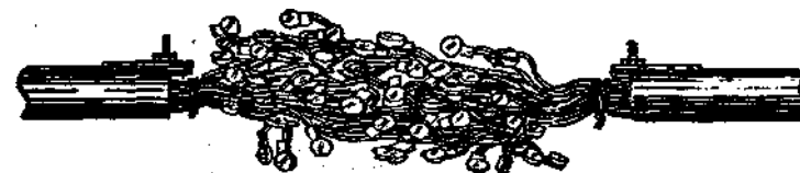
Рис. 4.11. Срасток жил, выполненный соединителем UY2.
