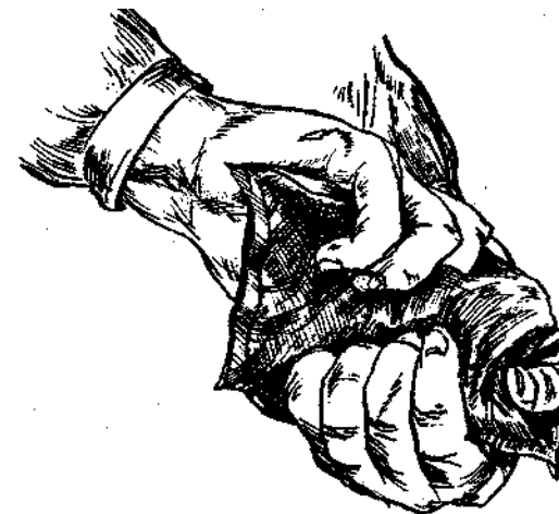
Рис. 4.18. Перемешивание компонентов компаунда 4442.
