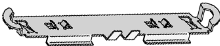
Рисунок 17 – Шина для крепления (заземления) экранов кабелей
